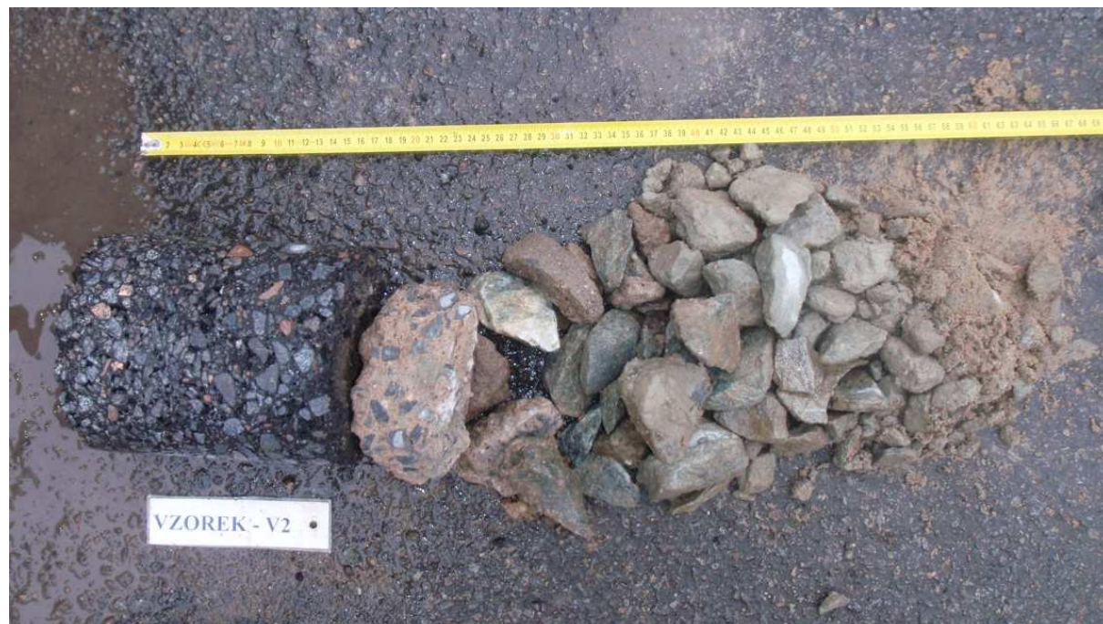
Obr. 3 - Jádro vývrtu Vzorek – V2 (in situ).
